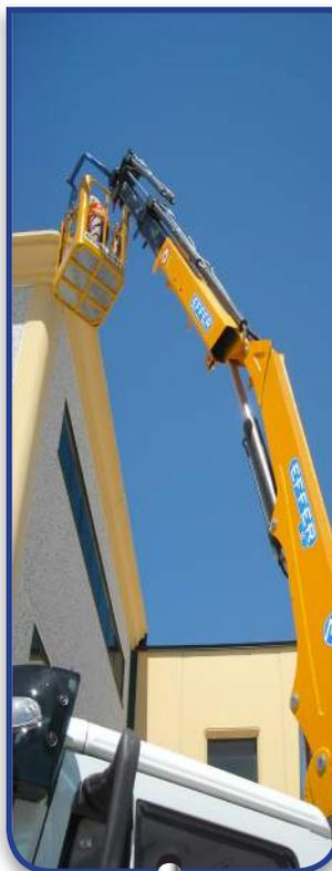
Gamme de grue hydraulique repliable pour camion, avec un rapport Puissance / Poids parmi les meilleurs du marché, et une capacité de charge 2t/m à 300t/m.
