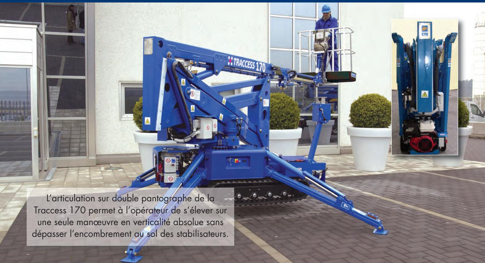
L'articulation sur double pantographe de la Traccess 170 permet à l'opérateur de s'élever sur une seule manœuvre en verticalité absolue sans dépasser l'encombrement au sol des stabilisateurs.
